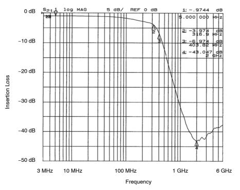
Figure 15. Filter 5 Insertion Loss (CM1461-08DE)
