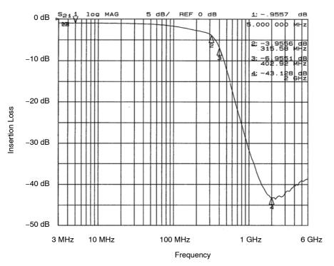
Figure 17. Filter 7 Insertion Loss (CM1461-08DE)
