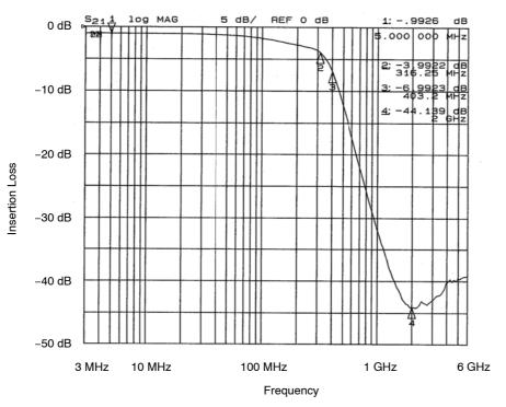
Figure 13. Filter 3 Insertion Loss (CM1461-08DE)
