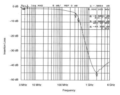
Figure 14. Filter 4 Insertion Loss (CM1461-08DE)
