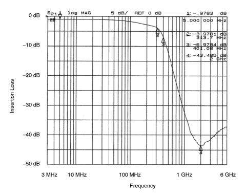
Figure 18. Filter 8 Insertion Loss (CM1461-08DE)
