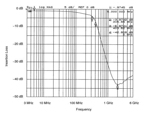
Figure 12. Filter 2 Insertion Loss (CM1461-08DE)
