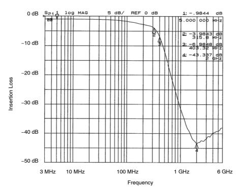
Figure 16. Filter 6 Insertion Loss (CM1461-08DE)
