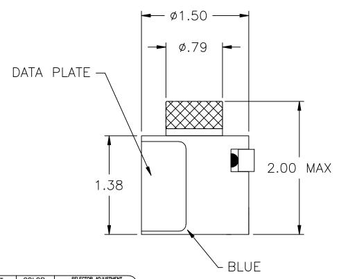
CONTACT DESIGNATION COLOR CODE SELECTOR ADJUSTM 0,75/1 mm<sup>2</sup> | 1,5 mm<sup>2</sup> | 2,5 mm<sup>2</sup> AWG 20 AWG 16 AWG 12 031-8554-000 031-8504-006 031-8556-000 RED/BLUE 5 031-8503-006 31-8556-006 31-8555-000 BLACK 030-8585-000 4 031-8557-000 YELLOW
