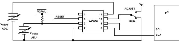
FIGURE 5. SAMPLE V<sub>TRIP</sub> RESET CIRCUIT
