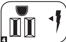
Salidas protegidas sólo contra sobretensiones
